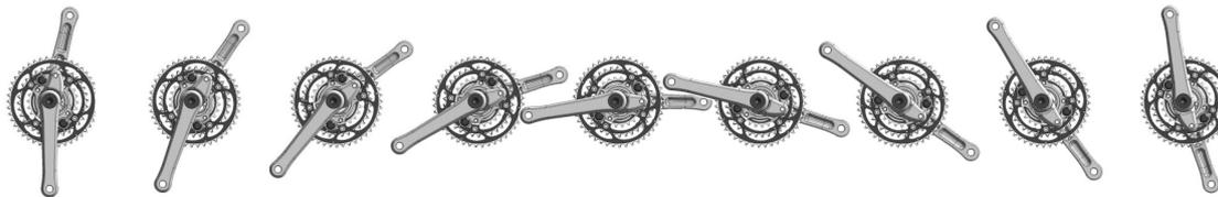
**Figura 1.** Padrão de movimento do sistema Rotor ao longo do ciclo de pedalada.
