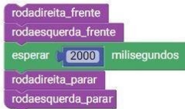
Figura 30 – Fazendo o carrinho andar para frente por 2 segundos e parar
