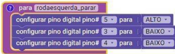
Figura 29 – Diagrama da roda esquerda: parar
