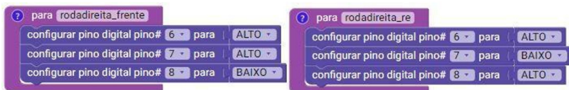
Figura 26 – Diagrama da roda direita: ré e frente
