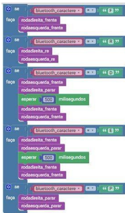
Figura 34 – Diagrama de blocos do recebimento para comparação do sinal recebido com o movimento desejado
