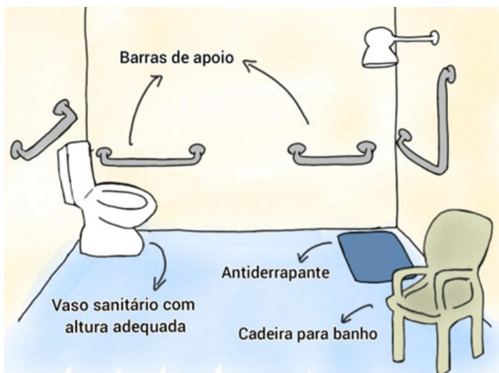
Figura 7 – Exemplo de banheiro antiqueda
