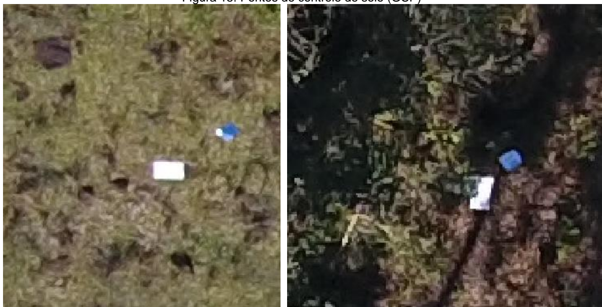
Figura 15: Pontos de controle de solo (GCP)
