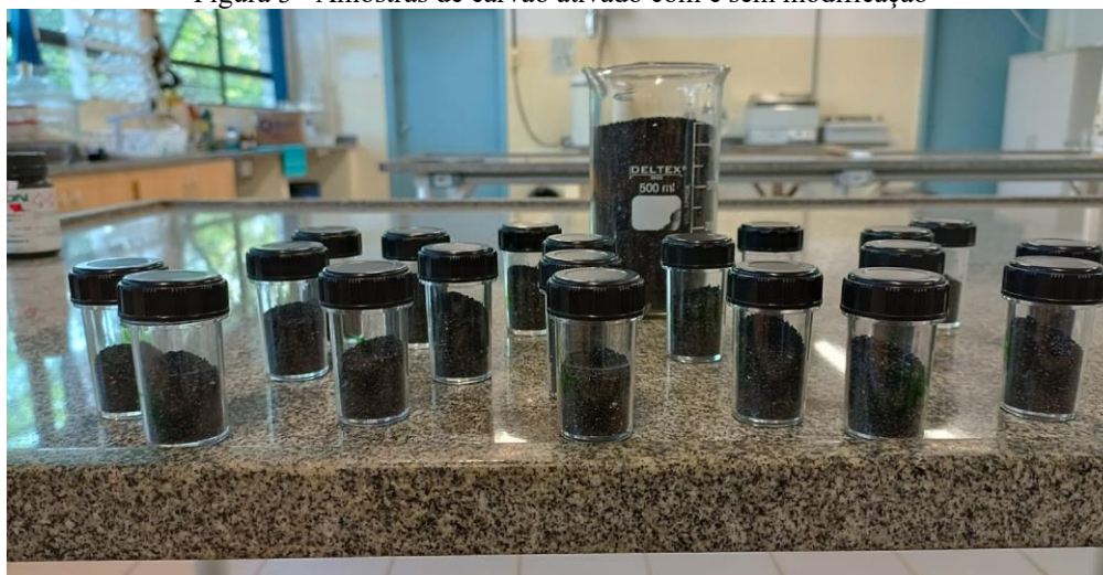
Figura 3 - Amostras de carvão ativado com e sem modificação
