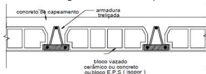
Figura 11 - Laje pré-moldada com vigota de armadura treliçada
