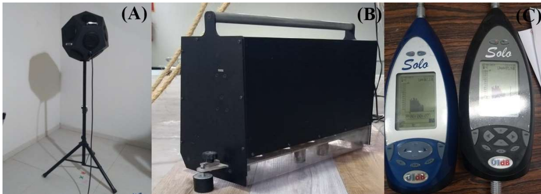
Figura 15 – Equipamentos utilizados – A) Fonte omnidirecional, B) máquina de impacto e C) medidores de nível sonoro
