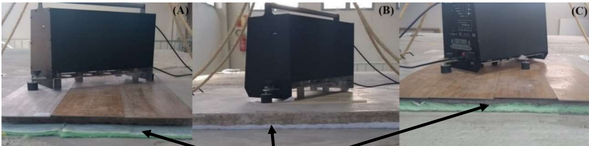
Figura 33 - Lã de poliéster, amostra A de 5 mm, B de 8 mm e C de 10 mm
