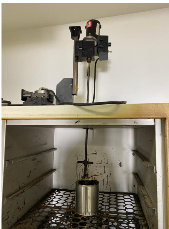
Figura 8 - 2ª etapa do processo de mistura (tempo de digestão).
