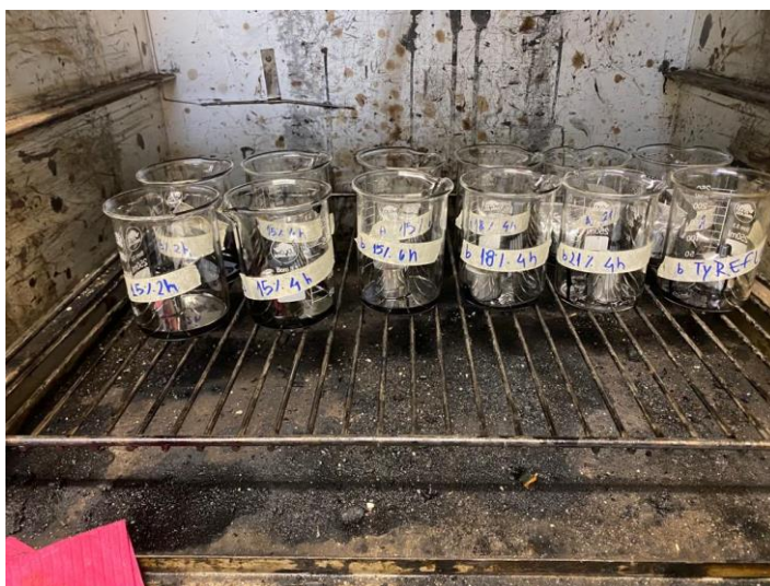
Figura 15 - Ensaio Separação de fases - (a) Amostras base e topo separadas (b) - Ponto de amolecimento base e topo.
