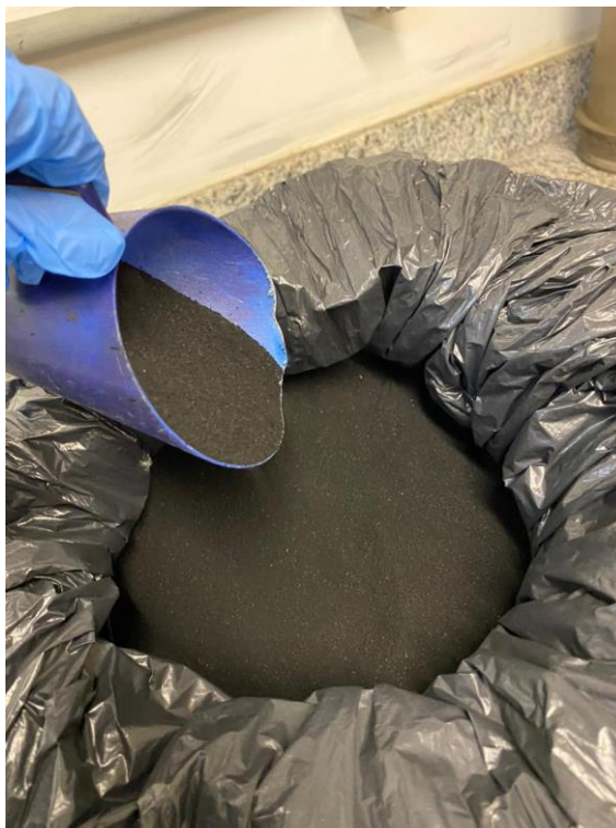
Figura 5 - Borracha triturada de pneu utilizada para a modificação do CAP.
