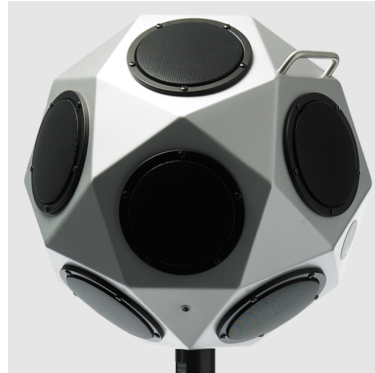
Figura 34 – Fonte Sonora Ominidirecional Dodecaédrica
