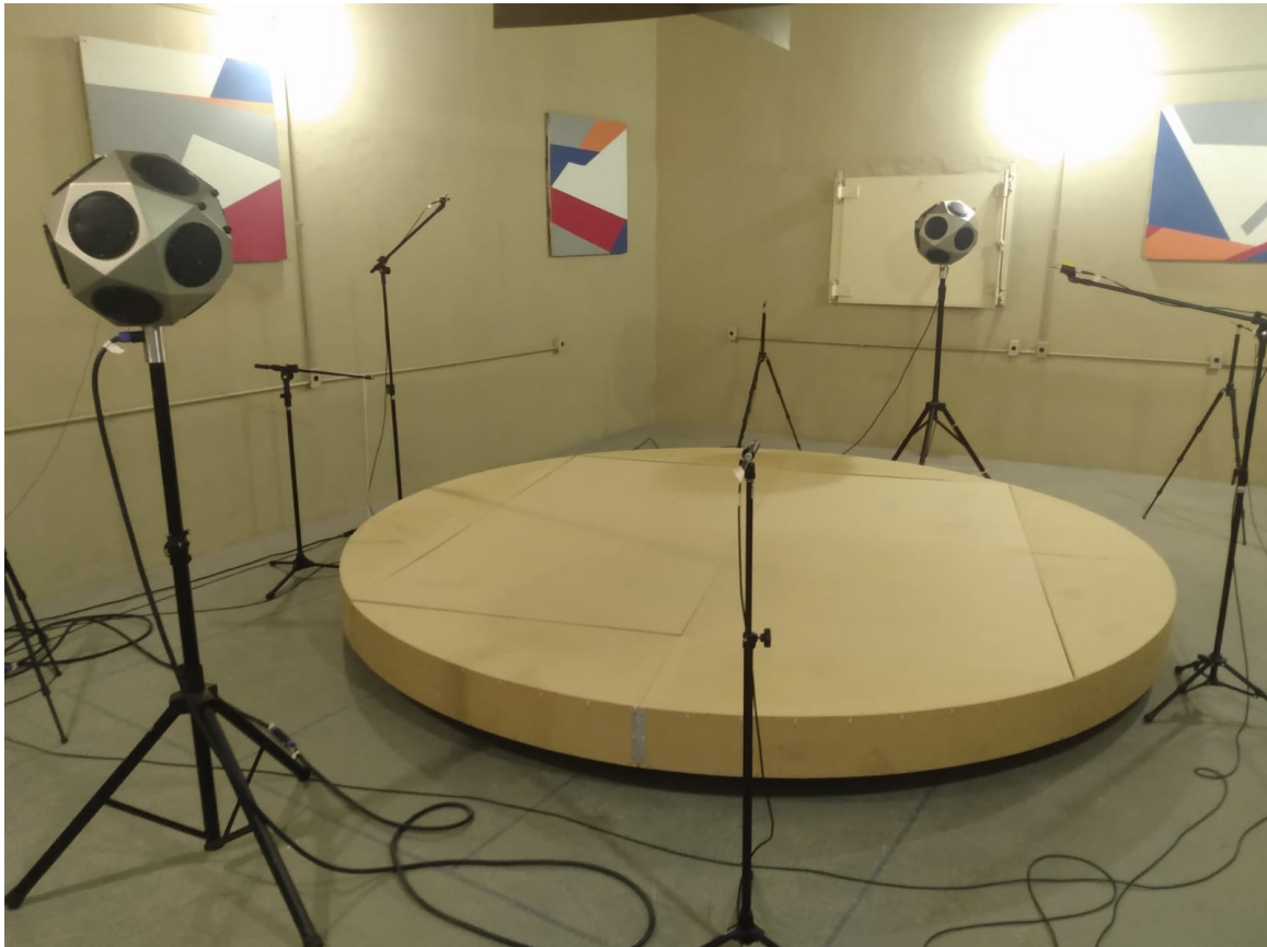
Figura 35 – Ensaio de coeficiente de espalhamento em câmara reverberante da mesa giratória sem amostras
