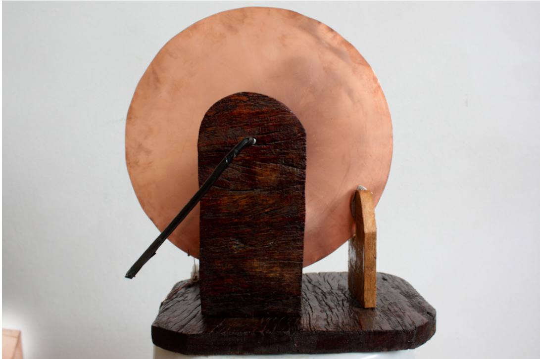
Figura 6 – Máquina homopolar de Faraday.
