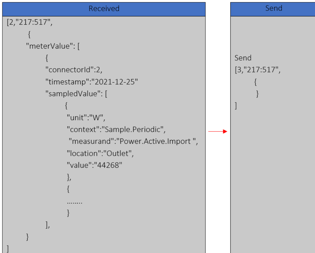
Figura 5 – Exemplo mensagem OCPP 1.6J MeterValues
