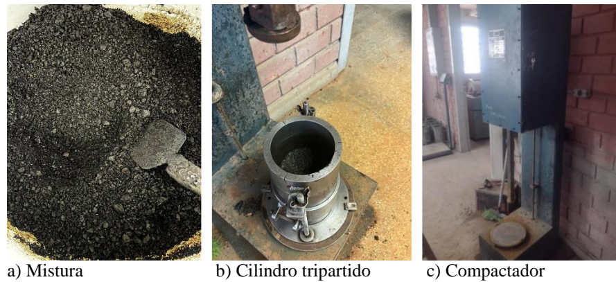
Figura 10 – Mistura e equipamentos utilizados na moldagem
