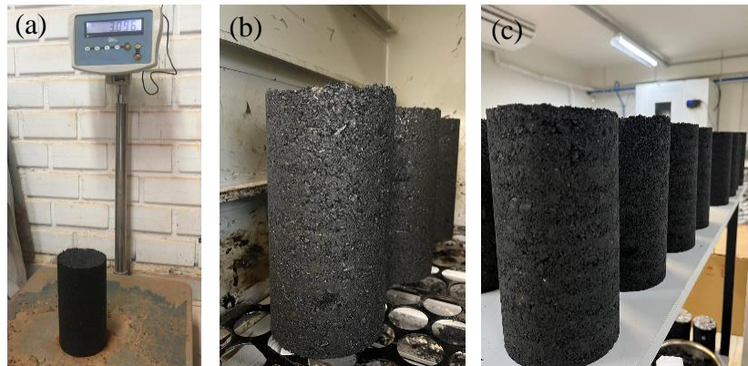
Figura 11 – Amostras prontas – (a) Pesagem do CP (b) CPs moldados curando em estufa à 60°C (c) CPs curados após 48h
