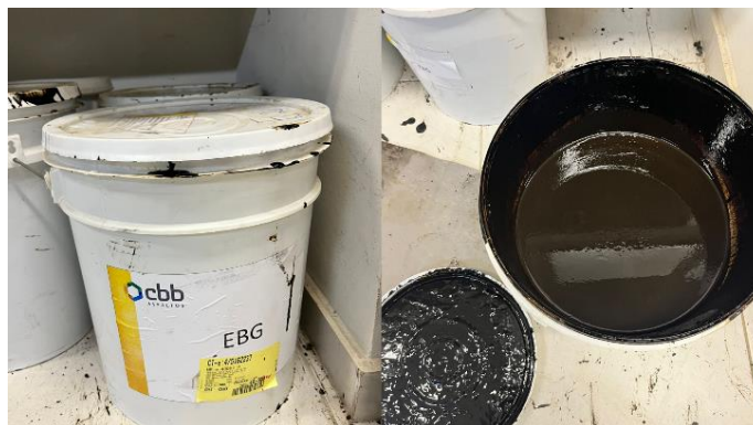
Figura 9 - Armazenamento das emulsões asfálticas utilizadas
