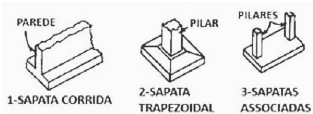
Figura 2 – Representação esquemática do elemento de fundação sapata.
