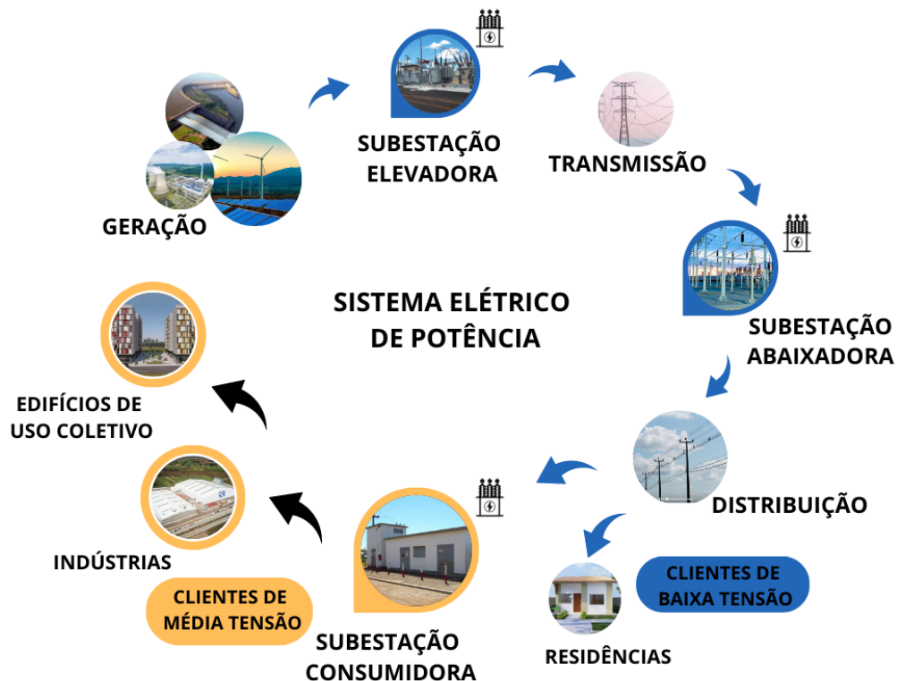
Figura 1 – Tipos de Subestações de Energia Elétrica
