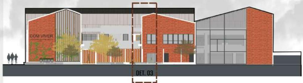
Fachada em Placa de Fibrocimento incombustível - espessura de 12 mm na cor cinza claro e textura de concreto, com paginação que varia de peças de 1,00 m x 0,50 m e 0,50 m por 1,00 m.
