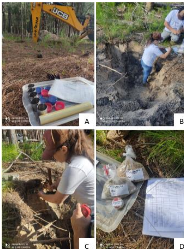
Figura 7 - Abertura da trincheira (A), coleta de amostras química (B) e física (C) do solo na área de estudo, embalagem (D).
