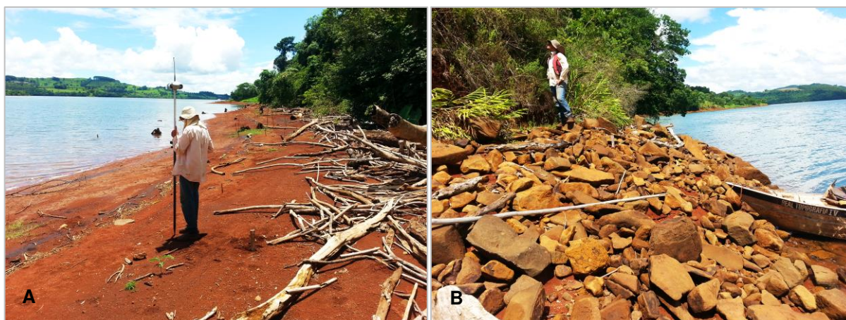
Figura 38 – A – Fisionomia geral de seção de monitoramento com talude inferior suave e ausência de blocos de rocha. B – Fisionomia geral de seção de monitoramento com talude inferior íngreme e densamente recoberto por blocos de rocha.
