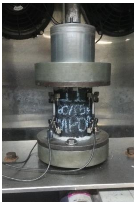
Figura 55 - Amostra no ensaio de fadiga uniaxial à tração direta
