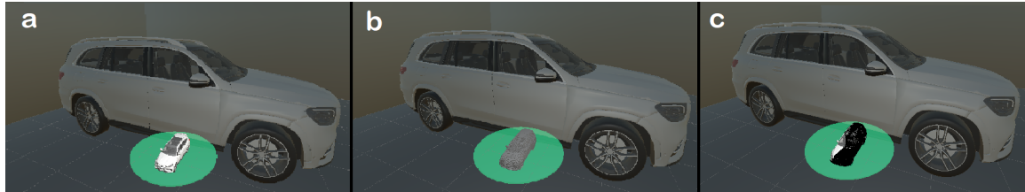
Figura 20 – Exemplo de 3 camadas tendo um carro como região de interesse. a. Miniatura idêntica. b. Simplificação. c. Área Visível
