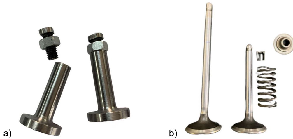
Figura 147 - a) tuchos com ajuste para válvula, b) válvulas de escape (original à esquerda e ajustada, à direita)
