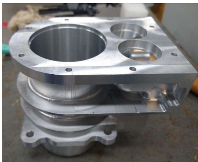
Figura 136 - cilindro usinado em CNC
