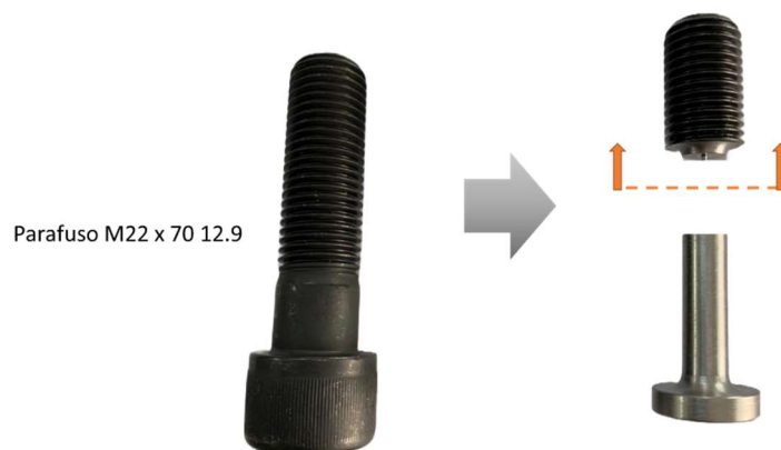
Figura 146 - Tucho de válvulas
