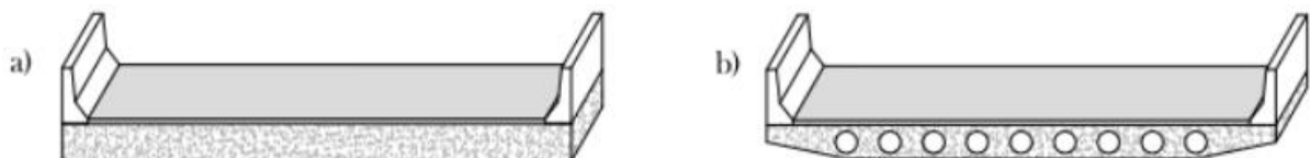
Figura 2 - Seções transversais típicas das lajes de pontes em vigas: a) seção maciça b) seção vazada
