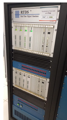
Figura 5. O hardware do RTDS
