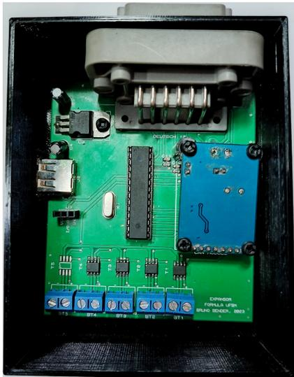
Fig. 5. Resultado da manufatura da caixa e PCB com componentes soldados.
