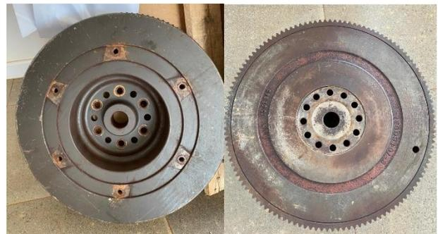
Fig.3. Volante utilizado de um motor de trator.
