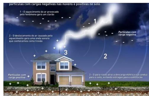
Fig. 1. Formação de descargas atmosféricas e funcionamento do SPDA.
