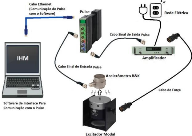
Figura 3-Esquema de Ligações da Bancada de Testes com os Equipamentos da Brüel & Kjaer.
