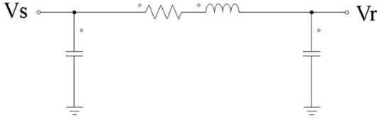
Fig. 2. Representação do circuito PI equivalente da LT.
