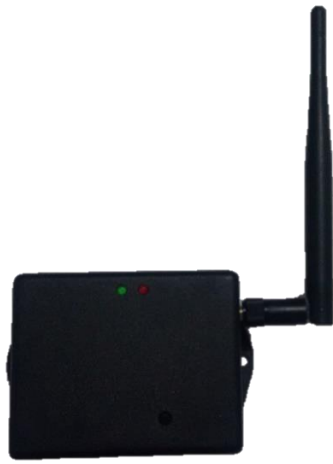
Fig. 4. Protótipo do repetidor LoRaWAN.
