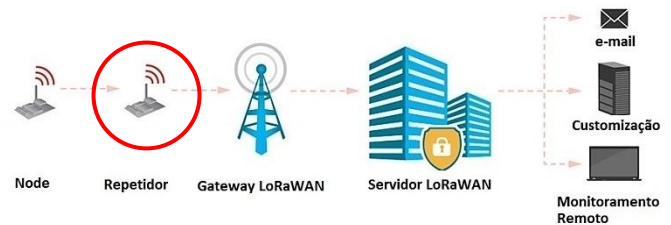
Fig. 7. Estrutura do segundo experimento (com repetidor na rede LoRa). Adaptada de [5].
