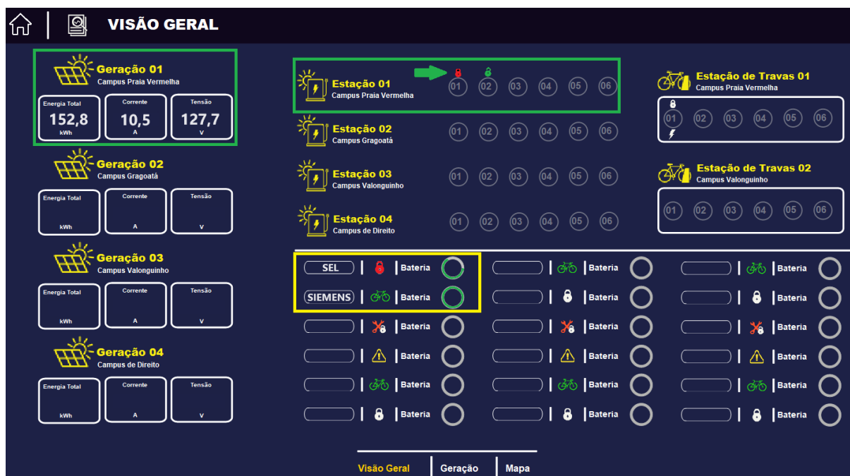
Figura 5: Tela SCADA de visão geral desenvolvida no Elipse E3.
