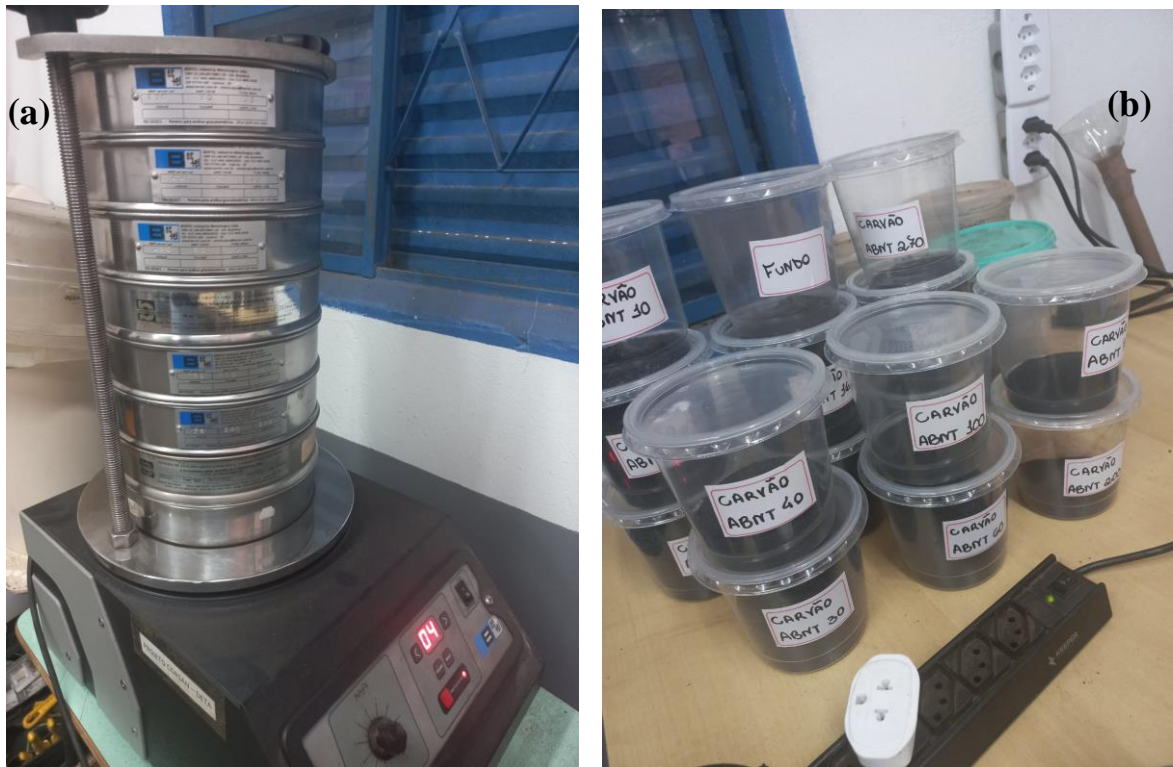
Figura 32 - Peneiramento e separação granulométrica do material filtrante.
