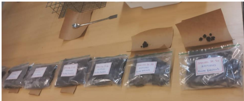
Figura 39 - Pesagem de cada amostra por camada, para cálculo de sólidos.
