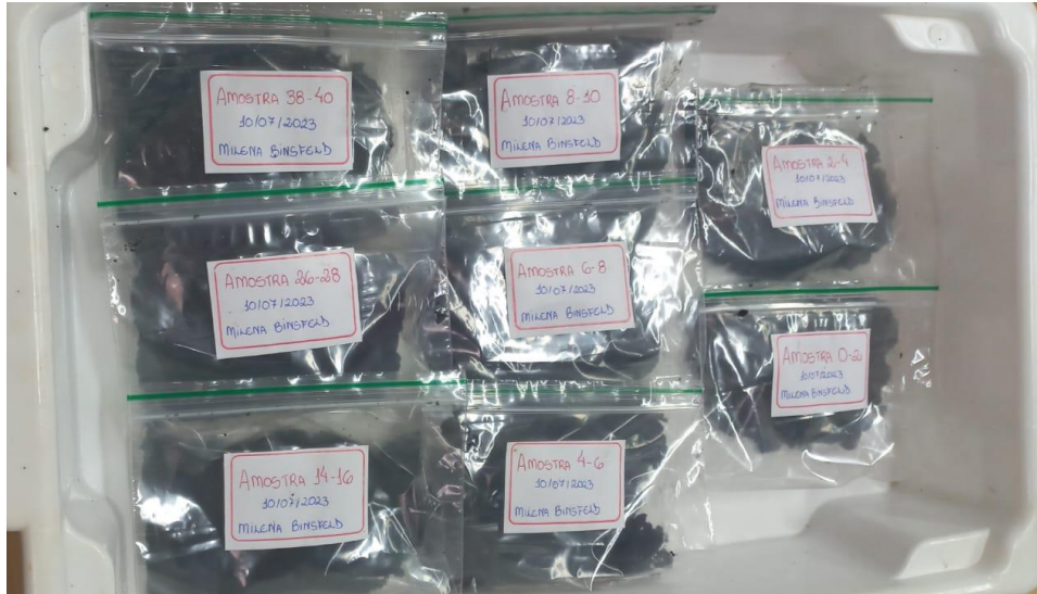
Figura 37 - Amostras coletadas por camada de influência de meio filtrante
