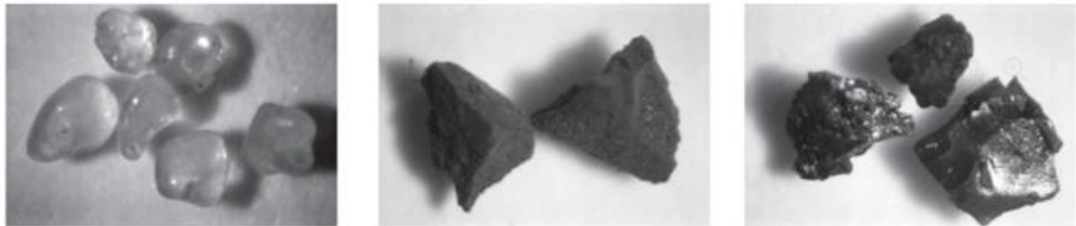
Figura 11 - Representação dos materiais filtrantes: Areia, Carvão Antracito e Carvão ativado granular, respectivamente.
