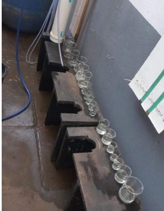
Figura 30 - Verificação da eficiência de limpeza do filtro durante a retrolavagem.
