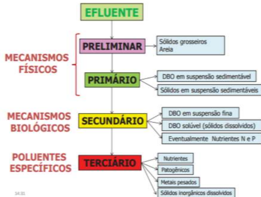
Figura 01: Etapas e mecanismos do tratamento de esgotos.
