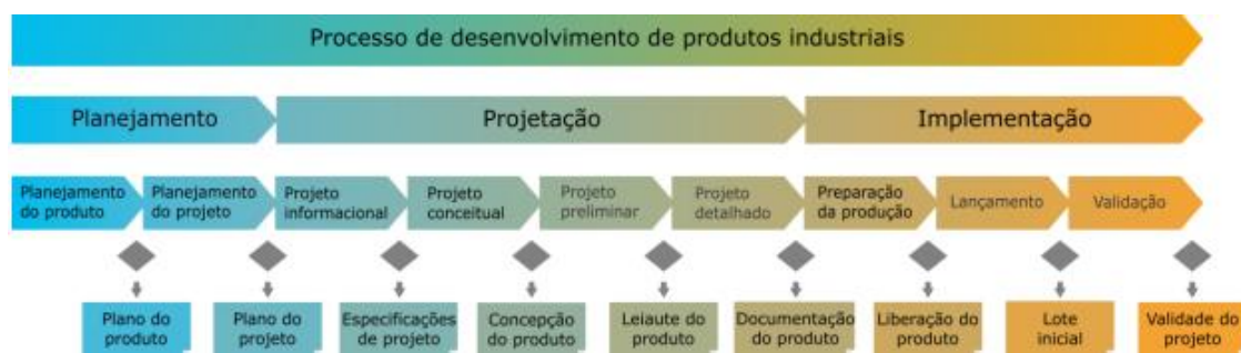
Figura 1. Representação simplificada do Modelo de Referência para o Processo de Desenvolvimento de Máquinas Agrícolas (Romano, 2003).
