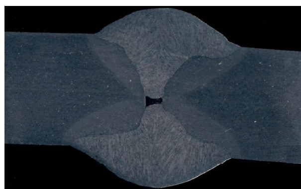
Figura 4. Macrografias da seção transversal da amostra soldada empregando o agente ‘antirrespingo’ marca 1.
