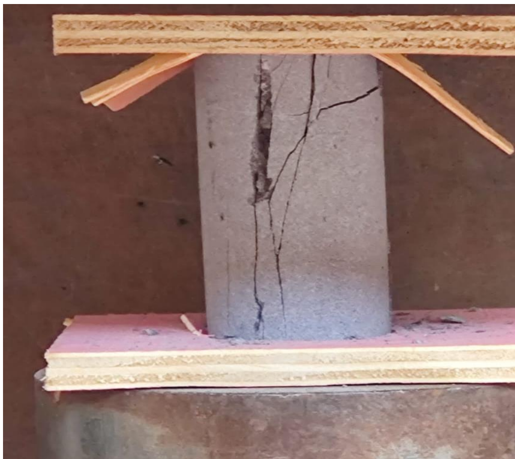
Figura 43 – Ruptura do corpo de prova 2
