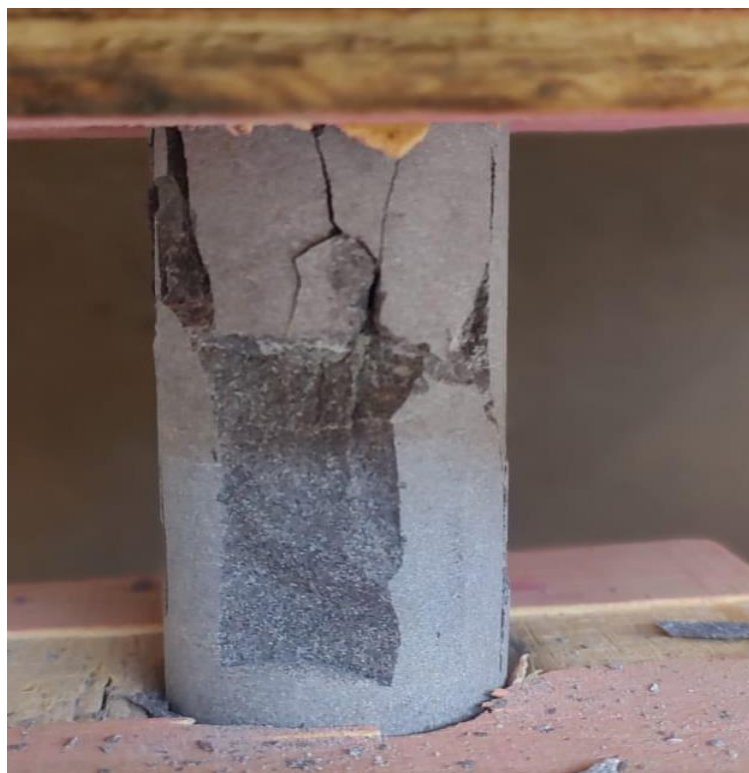
Figura 44 – Ruptura do corpo de prova 3
