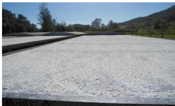
Figura 5 - Secagem do polvilho sobre piso cimentado (de concreto).
