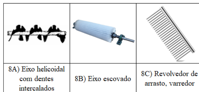
Figura 26 - Alimentar a máquina para que o polvilho entre na máquina (F.E.8).
