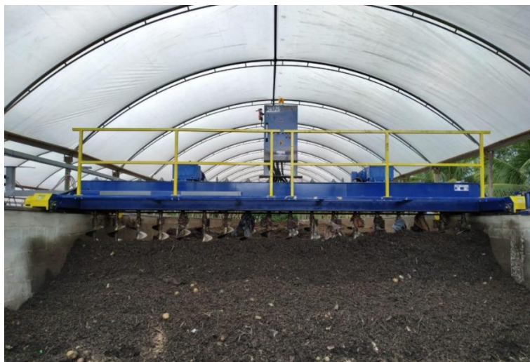
Figura 7 - Máquina operando revolvimento do solo, com hélices helicoidais na vertical.
