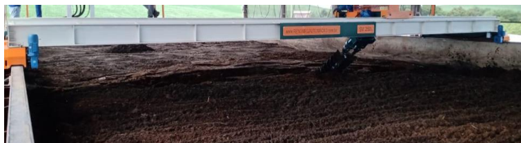
Figura 8 - Máquina operando o revolvimento do solo, com hélices helicoidais com um ângulo de inclinação.
