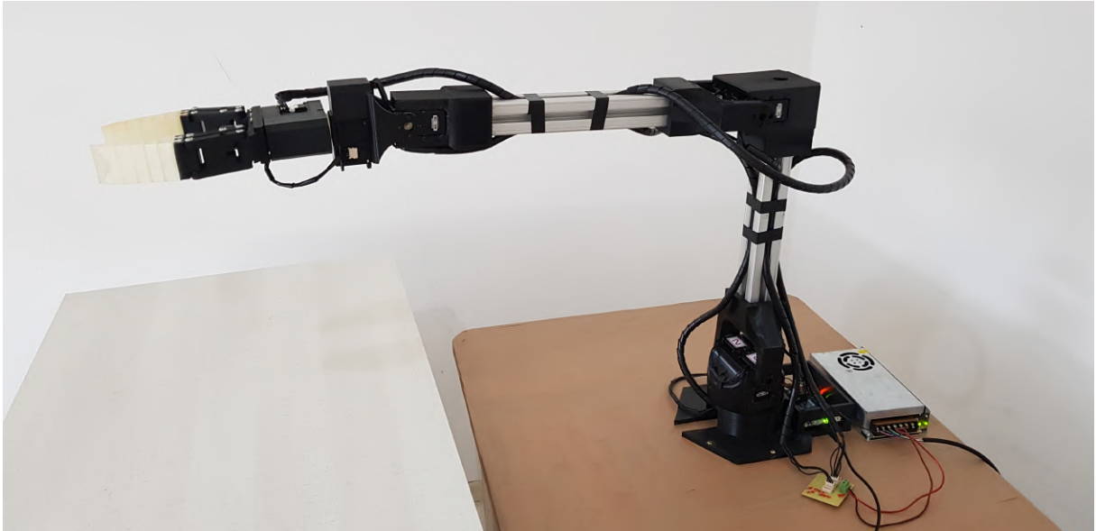
Figura 42 – Estrutura do manipulador totalmente montada.
