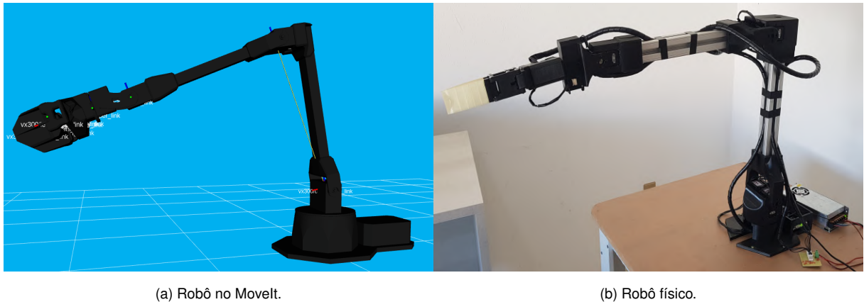
Figura 46 – Comparação para a posição home na interface do MoveIt e no robô físico.
