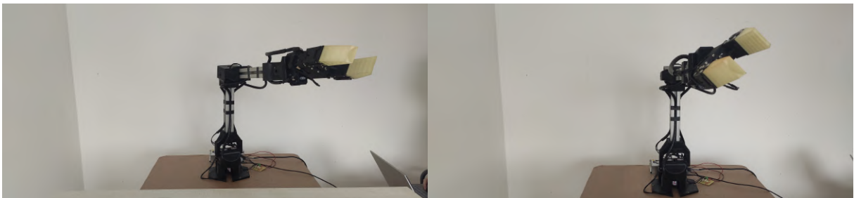
(e) Rotação de 45^\circ na junta do punho e de 45^\circ na junta da base.
