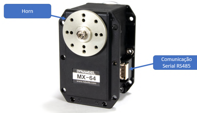
Figura 24 – Identificação do horn e da comunicação serial no motor.
