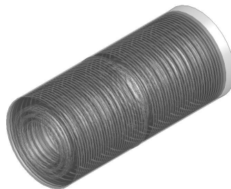
Figura 5 – Geometria simplificada da coluna do transformador.
