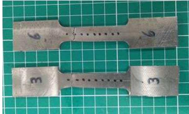
Figura 44: Amostras 3 e 6 apresentam estrição mais pronunciada.
