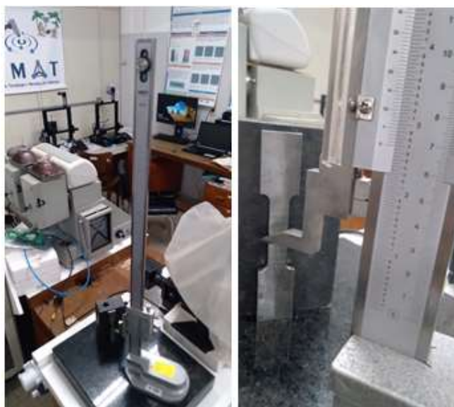
Figura 27: Em (A) traçador mecânico utilizado e em (B) as marcações realizadas para exatidão dos valores de comprimento.
