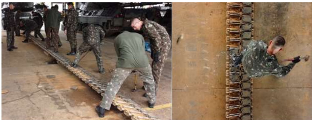
Figura 19: Processo de manutenção, para substituição das almofadas nos patins e a desmontagem realizada no conjunto.
