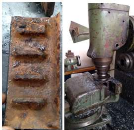
Figura 24: Amostra resultante do processo de corte sendo faceada por fresamento.
