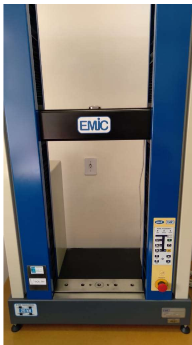
Figura 11: Exemplo de máquina universal para ensaio de tração, presente no LADIPP-UFSM.
