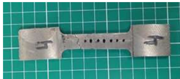
Figura 45: Amostra 4 com pouca deformação plástica.
