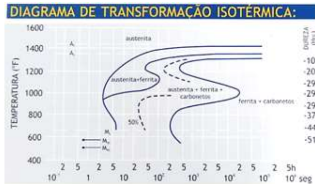
Figura 9: Exemplo de curva de transformação isotérmica, para um aço 4140.
