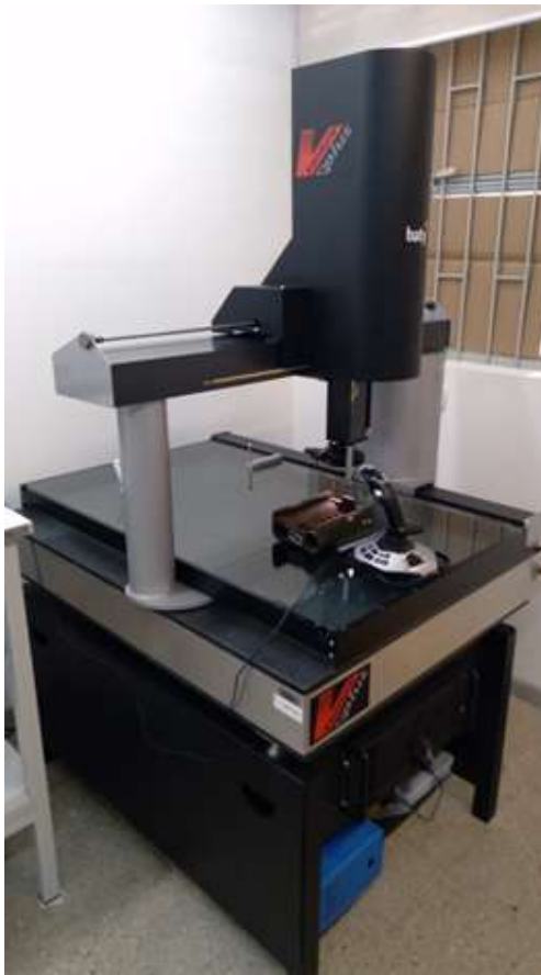
Figura 21: Máquina Fowler Baty Venture Plus usada para as medições da telha do Leopard 1 A5 BR.
