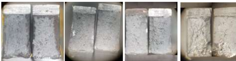
Figura 32: Fraturas das amostras, após Ensaio de Impacto (Charpy)
