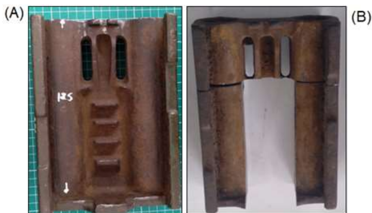
Figura 23: Em (A) telha antes de corte. Em (B), amostra após o corte.
