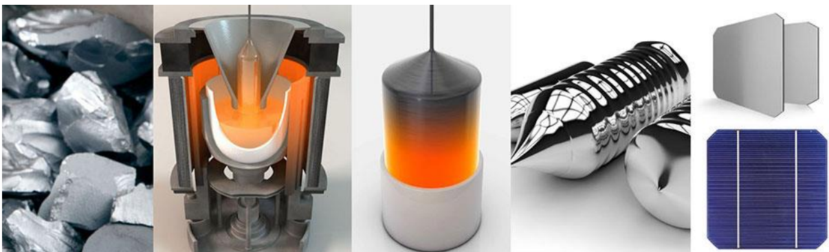
Figura 3 - Etapas na fabricação de células fotovoltaicas monocristalinas
