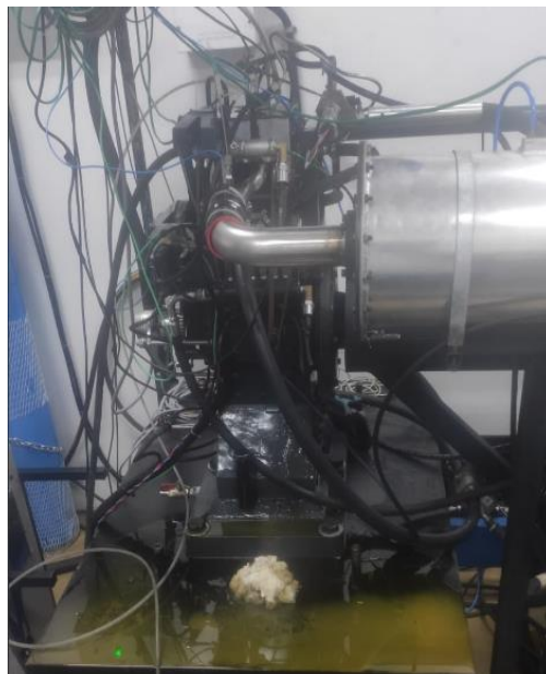
Figura 79 – Ocorrência do vazamento de óleo.
