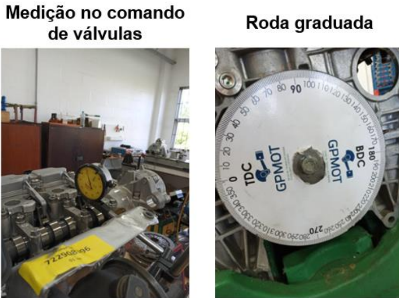
Figura 26 – Aparato experimental para medição de levantamento de válvula de exaustão do motor de referência.
