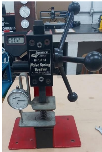
Figura 80 - Equipamento utilizado para a obtenção da curva FxD da mola de válvulas.
