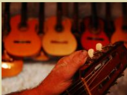
5. Tarrachas – fornecidas por lojas especializadas – são montadas na “mão” do violão. Servem para afinar o instrumento.
