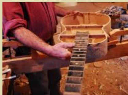
3. São acrescentados o braço e os trastes (segmentos no braço do violão, feitos de tiras de metal branco).
