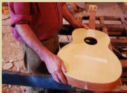
4. O tampo é feito com um compensado de marfim imperial onde são fixados o cavalete e o rastilho.
