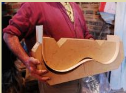
2. Com a cola seca, então, o mesmo molde é utilizado para fazer o outro lado que formarão o corpo do violão.
