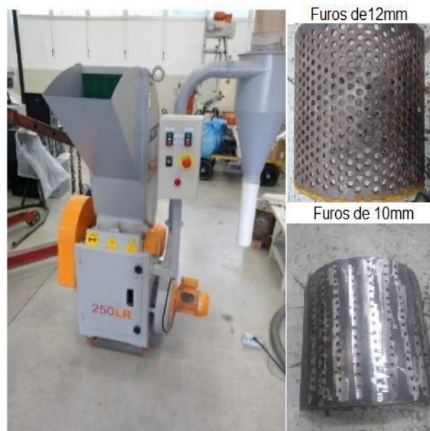
Figura 8 - Moinho de facas utilizado no processo de moagem
