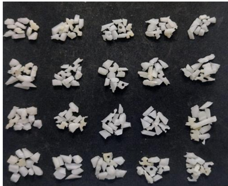
Figura 25 - Amostra de 200 grãos de obtidos pela peneira com furação de 12 mm
