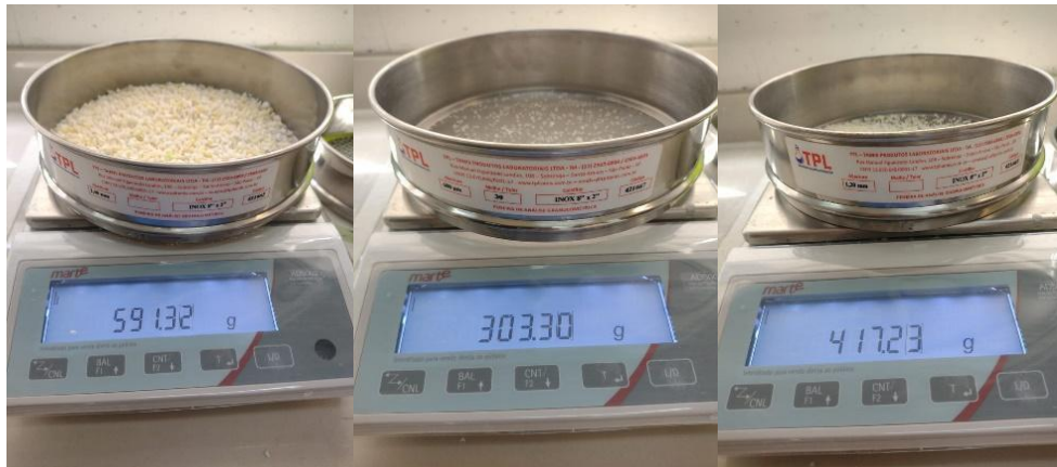
Figura 23 - Material retido de acordo com NBR NM 248 para análise de granulometria.
