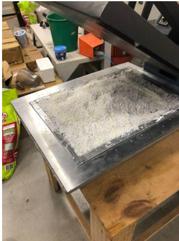
Figura 33 - Distribuição do material moído no molde
