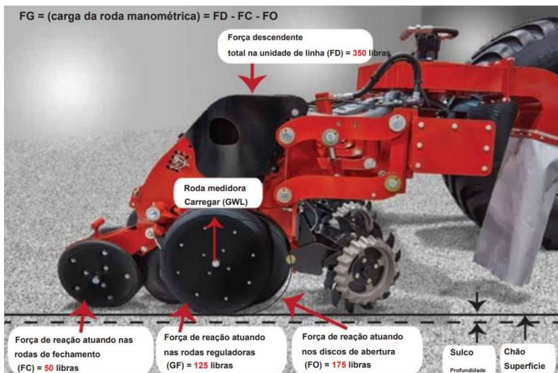
FIGURA 4 – Modelo exemplificado da funcionalidade do downforce
