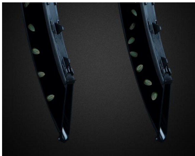
FIGURA 14 – Sementes em condições regular e sementes com colisões seguidas no tubo condutor
