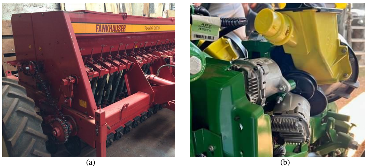
FIGURA 12 – Mecanismos de acionamento do sistema de dosagem: (a) acionamento roda terra e (b) acionamento elétrico
