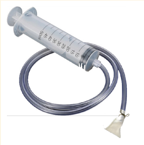
Figura 5 - Montagem da seringa com o tubo de plástico protegido pelo tecido na ponta para simular o bombeamento de água pelo poço.
