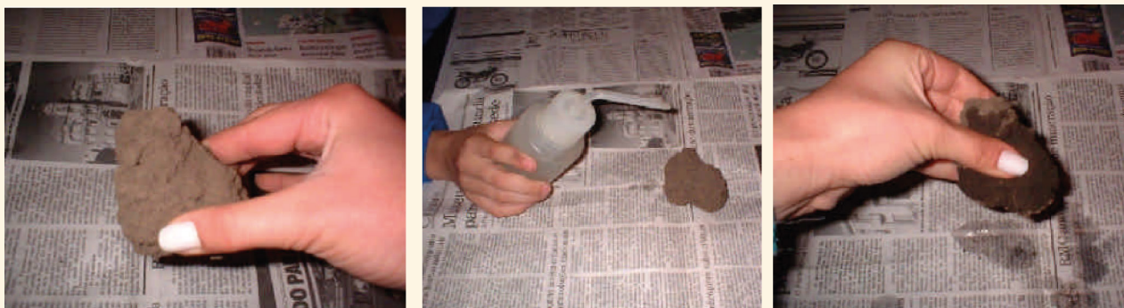
Figura 19 - Experimento para avaliação da textura do solo, verificando a resistência da amostra seca e depois do gotejamento de água.
