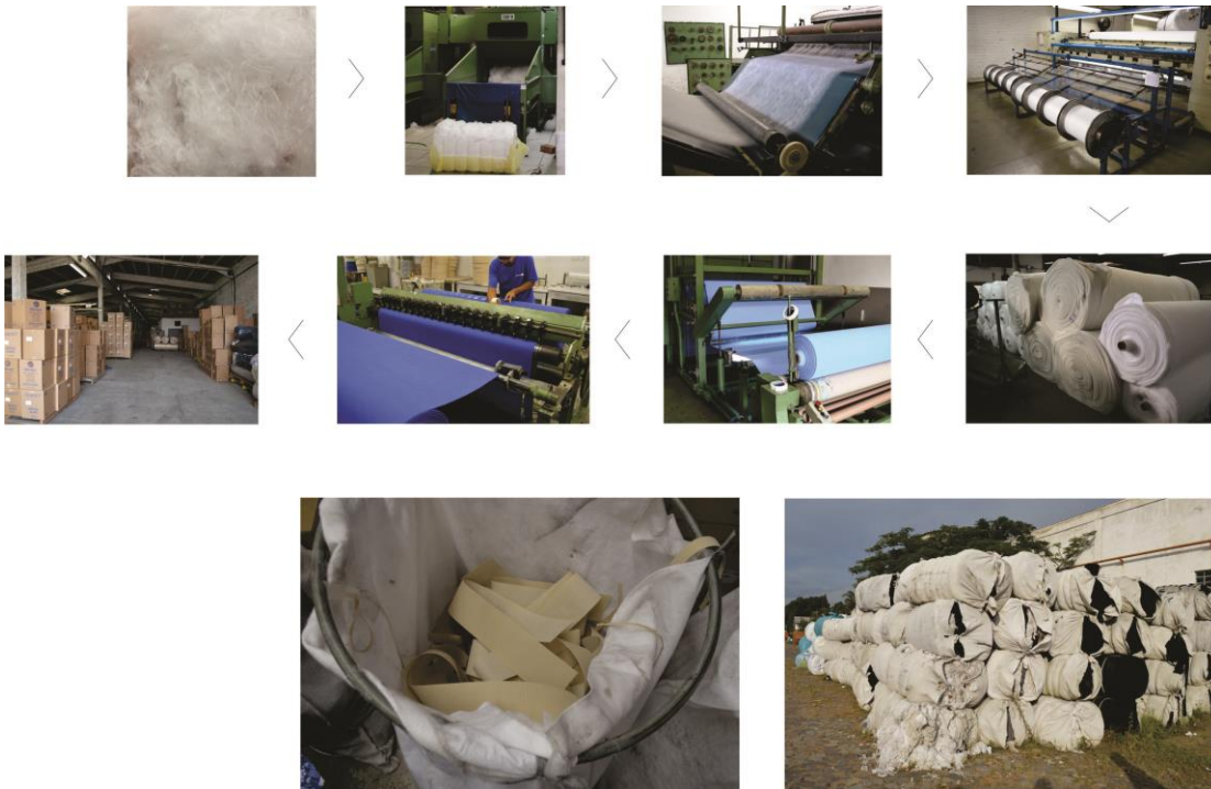
Figura 36 - Etapas de produção das cortinas persianas na indústria Inbrape e resíduos gerados.
