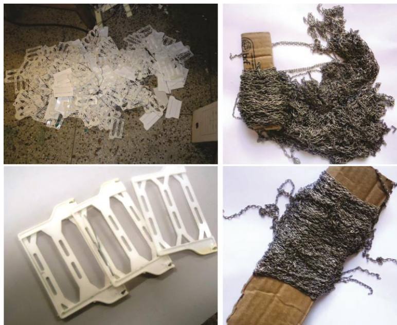
Figura 98 - Peças plásticas e correntes selecionadas da separação das cortinas persianas.
