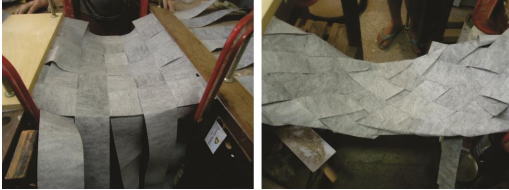
Figura 72 - Tramas após o teste de resistência.
