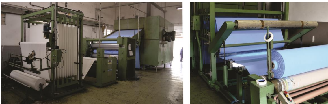
Figura 16 - Máquina onde é aplicada a tintura e resina.
