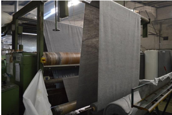
Figura 15 - Mistura de fibras brancas e pretas que formam o TNT cinza.
