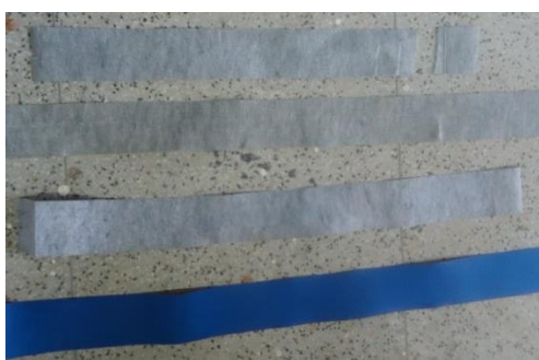
Figura 50 – Lâminas das persianas após o teste de resistência.
