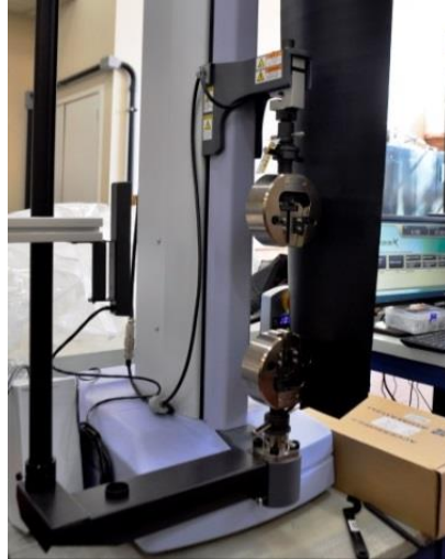
Figura 51 - Máquina que realiza o ensaio de tração em materiais.
