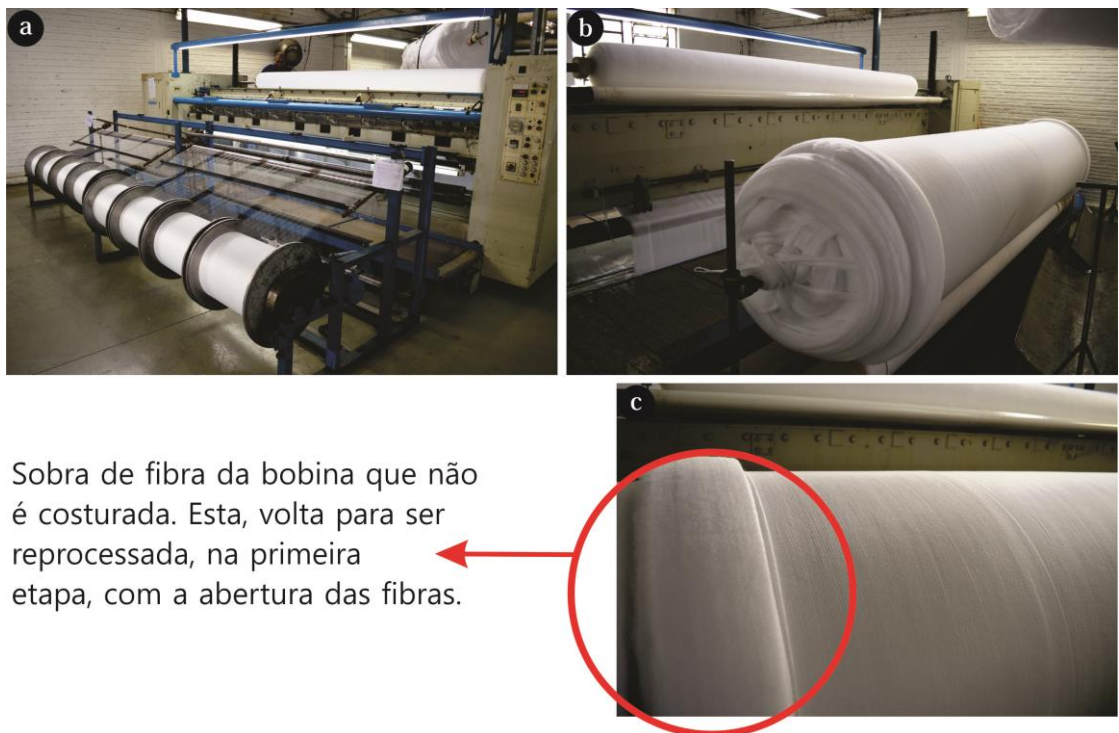
Figura 13 - a) Costura das camadas de fibra. b) Bobinas de tecido-não-tecido. c) Detalhe do TNT costurado e da sobra de fibra não costurada.
