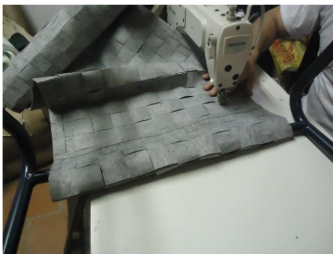
Figura 89 - Costura do tramado na estrutura.
