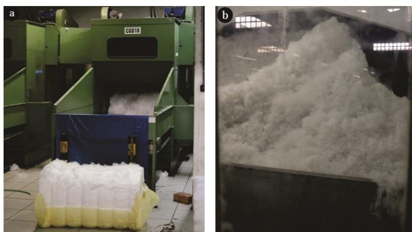
Figura 11 – a) Máquina abrindo as fibras. b) Câmara onde as fibras são armazenadas depois de abertas.
