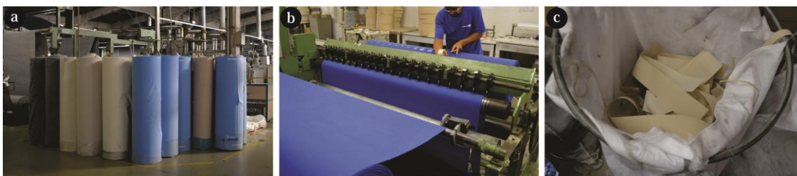
Figura 17 – a) Bobinas após o tingimento. b) Realização do corte do TNT para persianas. c) Resíduos decorrentes desse processo.
