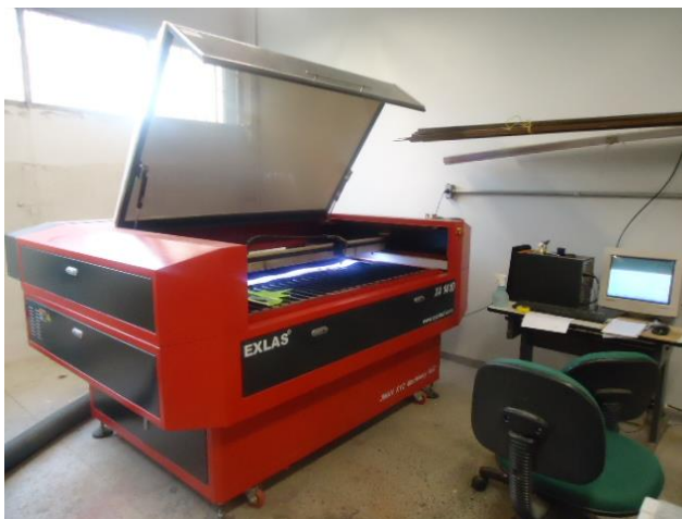
Figura 47 - Máquina que realiza o corte a laser .
