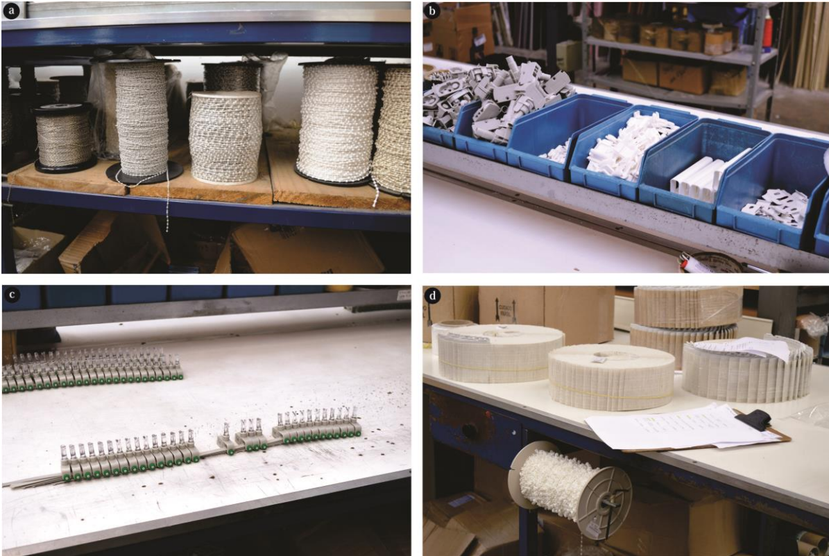
Figura 21 - Componentes utilizados para a montagem das persianas. a) Correntes de metal e de polímero. b) Diversas peças de polímero utilizadas para a fixação das lâminas de persiana. c) Estrutura que sustentará as persianas. d) Persianas após montagem, prontas para a embalagem.
