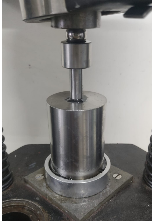
Figura 7 – Molde cilíndrico de compactação de amostras.
