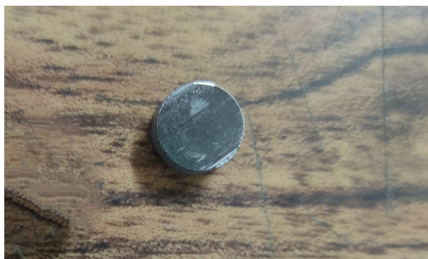
Figura 14 – Amostra cortada a fim de visualizar boa sinterização.
