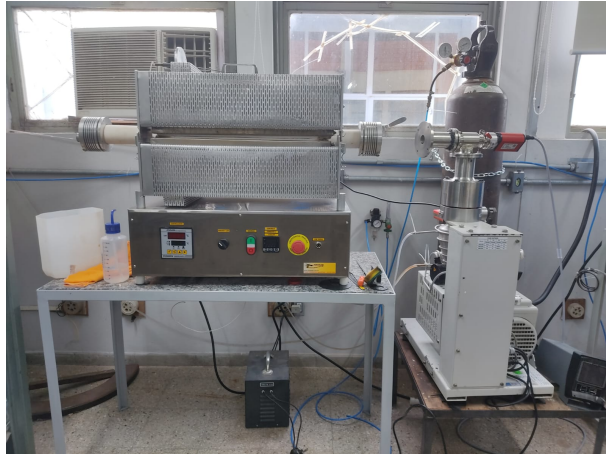
Figura 8 – Forno sob condições de vácuo utilizado para sinterizar as amostras.
