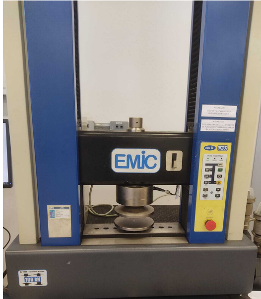
Figura 12 – Máquina eletromecânica para realização do ensaio de compressão.
