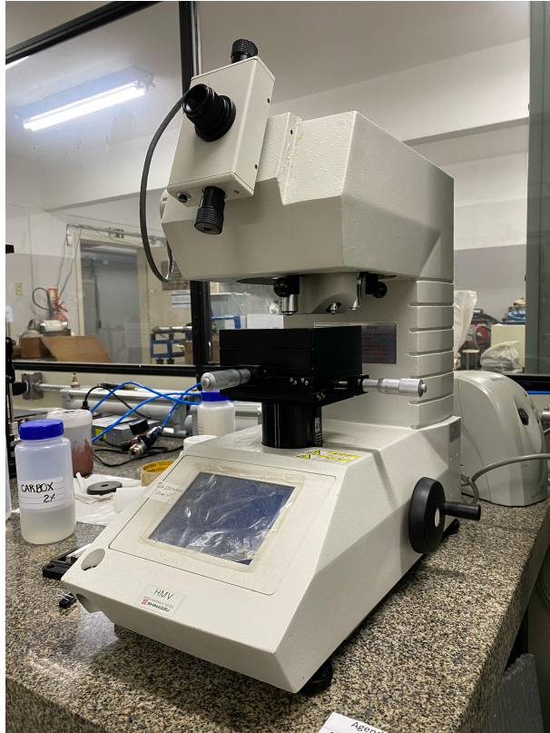
Figura 11 – HMV Shimadzu utilizado para realizar o ensaio de microdureza Vickers.
