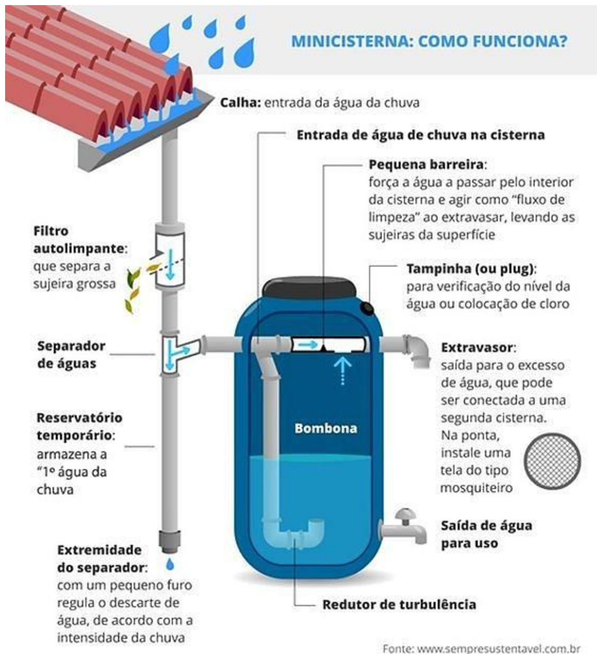
Figura 5 – Sistema de aproveitamento pluvial de baixo custo, com tubo de PVC utilizado como reservatório de descarte das primeiras águas.
