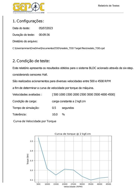
Figura B.7 – Relatório gerado para a construção da curva de torque por velocidade.
