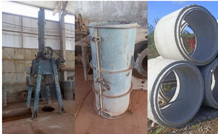
Figura 8 – Máquina de fabricar tubos em concreto da empresa em estudo
