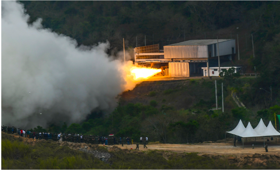
Figura 2 – Teste estático do motor S50
