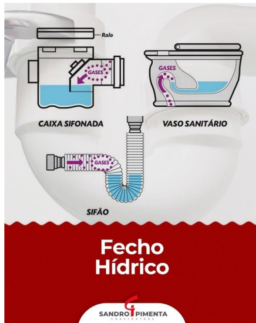
Figura 6 - Funcionamento do fecho hídrico
